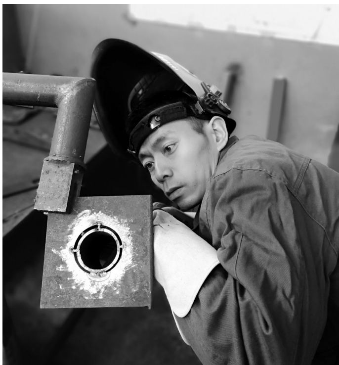
2020年3月，吴勇刚在进行6G仰焊位的管板焊接操作
