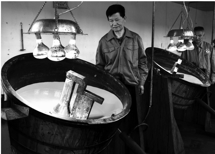
余继先（左）正在察看生漆精制搅拌机内漆液脱水聚合情况
